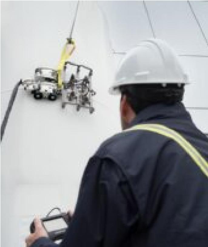
SteerROVER便携式电动扫查器基于已经过野外验证的MapROVER扫查器而开发, 而且具有更强的导向性能, 操作人员可以远程方式自如地控制这款扫查器。在检测过程中, 难以接触到的大面积铁磁性区域, 如: 压力容器和箱罐, 如今不再遥不可及, 高不可攀。扫查器经过配置后, 借助一种电动光栅臂可以完成腐蚀成像操作, 还可以借助一种支撑探头托架的支架, 对焊缝进行检测。
